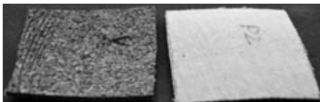
Fig. 7. Acoperiș de branț din plută
